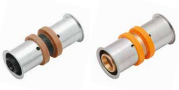
Joon. 50. KAN-therm ultraPRESS-liitmik PERTAL, PEXC, PERT ja blueFLOOR PERT torudele läbimõõduga 14 × 2, 16 × 2, 20 × 2, 25 × 2,5 mm.
